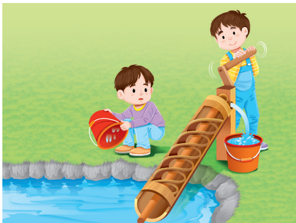
圖 1 阿基米德螺旋提水器
