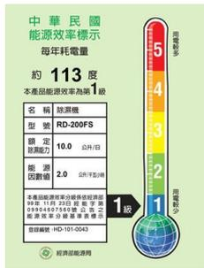
圖 5-12 能源效率標示圖(1 級)
