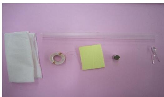
圖 1-3 搖搖發電機實驗器材
