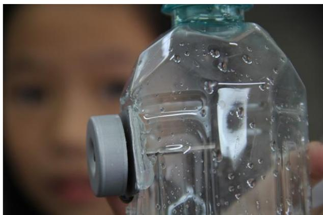
5. 以熱熔膠槍在發電機與寶特瓶交接處做補強。
