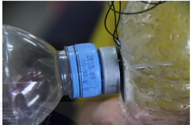
8. 將剪成扇葉的寶特瓶瓶蓋處以熱熔膠與發電機組黏合。
