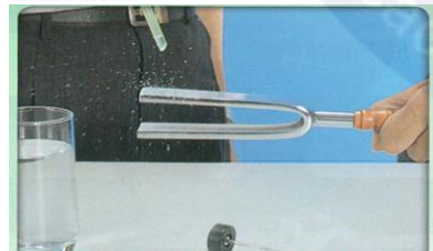
敲打音叉後，用吸管吸一些水滴在音叉上，音叉產生的振動會使水滴被彈開，成為更小的水珠。 敲打音叉後，將水滴在音叉上。
