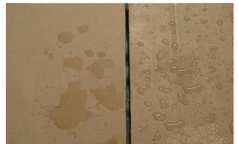
圖 4-3 圖的「右側塗有奈米無膜撥水防護劑」；圖的「左側無塗抹」。
