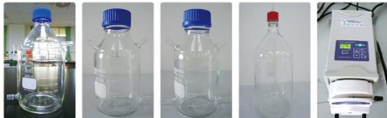
甲、厭氧發酵槽 乙、氫氣純化瓶 丙、氣液分離瓶 丁、基質槽 戊、攪動幫浦
