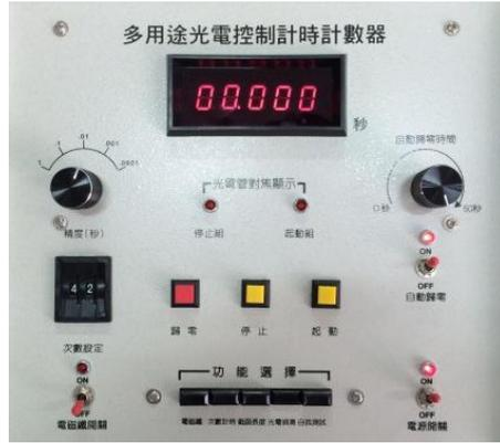
圖 4-3 光電控制計時器
