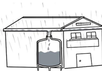
下雨時，雨水會沿著屋簷流入溝渠，最後接到雨水撲滿裡。
